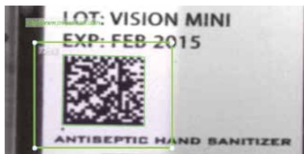
Lee un código de barras o código 2D. Gracias a la función de correspondencia de cadenas, esta cámara inteligente puede efectuar una verificación habitualmente realizada mediante un PC o PLC.
