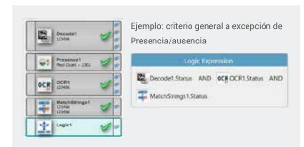
Realiza una operación lógica y compara los tamaños de los resultados de las herramientas. La operación lógica de «estado» de cada herramienta se puede utilizar para crear condiciones de criterio individuales en lugar de la condición general.
