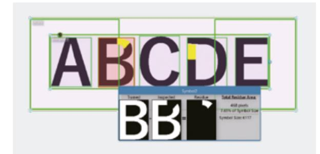
Detecta defectos de las cadenas de caracteres medidas utilizando la cadena de caracteres de referencia registrada. Se enfoca automáticamente en una cadena de caracteres de destino, incluso si su posición es diferente.
