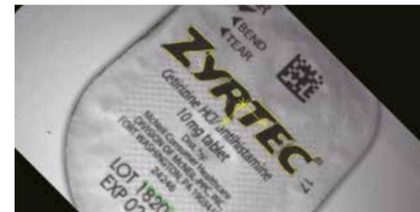
Genera la posición y el ángulo de la imagen registrada. El área de inspección de esta herramienta se puede utilizar automáticamente para el procesamiento que sigue a esta herramienta.
