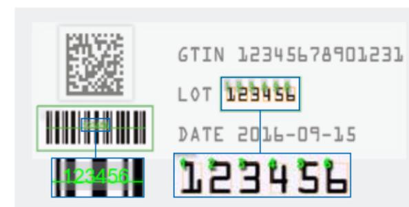
Compara la lectura de una cadena de caracteres legible por las personas mediante OCR con los datos contenidos en el código leído mediante CR, lo que se suele realizar mediante PC o PLC.
